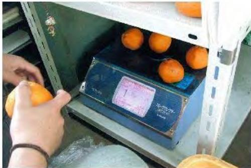
非破壊糖酸度測定器による選別
