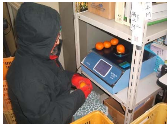
写真 5 非破壊糖酸度測定器による選別
