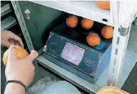
写真Ⅱ-37 非破壊糖酸度測定器による選別
