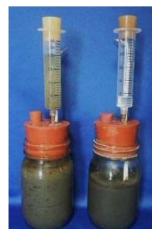
図3 キット試作機による培養状況 キットは培養槽、30℃加温用ヒーター、密栓培養容器、Eh測定用の簡易Eh計と電極、培養容器内のガス発生量測定用のガスゲージなどにより構成される
