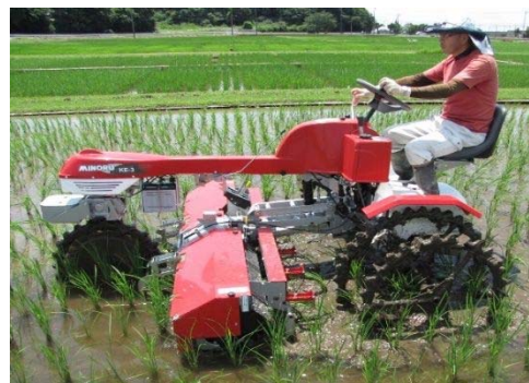
図 1 高能率水田用除草機(6 条タイプ)
