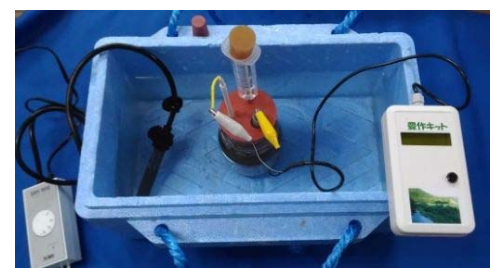
図3 キット試作機による培養状況 キットは培養槽、30℃加温用ヒーター、密栓培養容器、Eh測定用の簡易Eh計と電極、培養容器内のガス発生量測定用のガスゲージなどにより構成される
